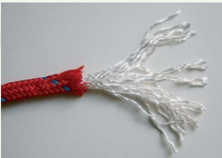
10-миллиметровый плетеный трос с 16-рядной полиэфирной сердцевинной и 24-рядной полиэфирной же оболочкой
