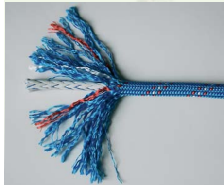
10-миллиметровый композитный плетеный трос с 32-прядной оболочкой из полиэфира и 12-прядной плетеной сердцевинной из «Дупеета»
