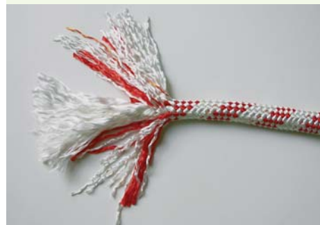
12-миллиметровый плетеный трос с 32-прядной полиэфирной сердцевинной и 32-прядной полиэфирной оболочкой
