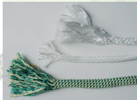
12-миллиметровый композитный плетеный трос для гоночной яхты в «разобранном» виде: внизу – 32-прядная полиэфирная оболочка, вверху – 8-прядная сердцевина из «Дупеета», посередине – 12-прядная промежуточная оболочка из полиэфира
