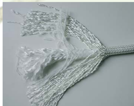
16-миллиметровый композитный плетеный шкот для суперяхты: оболочка – 32-прядная полиэфирная; промежуточная полиэфирная оболочка – 24-прядная «противоскользящая», сердцевина – 32-прядная плетеная из «Дупеета»
