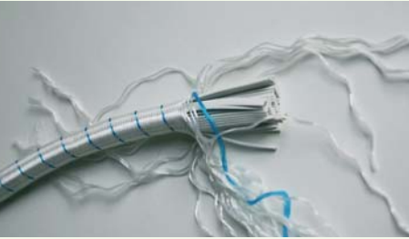
10-миллиметровый трос редко встречающейся конструкции: под тонкой оплеткой из полиамида находятся резиновые жгуты. Такой трос хорошо амортизирует рывки и предназначен для швартовых концов.
