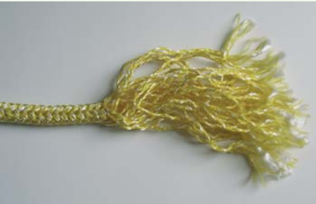
10-миллиметровый 32-рядный безоболочечный плетеный трос для гоночной яхты из полиэфир и кевлара
