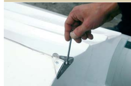
Стальной тросик, уложенный в канавку на киле, крепится за обушок на форштевне и натягивается гайкой на транце
