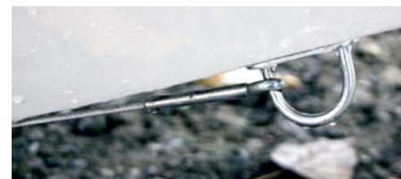
Стальной тросик, уложенный в канавку на киле, крепится за обушок на форштевне и натягивается гайкой на транце
