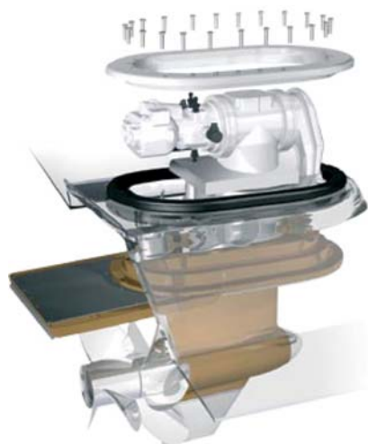
Принцип установки нового привода от «MerCruiser» такой же, как у «IPS»
