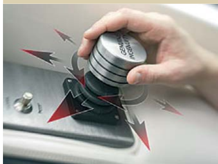
Стрелками показано, как будет двигаться судно при отклонениях руля джойстика или ее вращении
