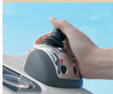
С недавних пор и «IPS» тоже управляется компьютерной системой с джойстиком
