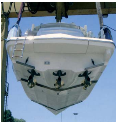
Для установки третьего «IPS» по ДП корпус «Absolute 56» потребовалось дополнить специальной отформовкой
