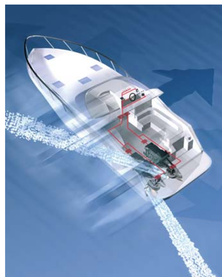
С недавних пор и «IPS» тоже управляется компьютерной системой с джойстиком
