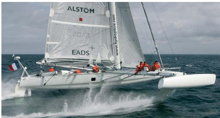
При этом требовалось изменить аэродинамику мачты и всего парусного вооружения так, чтобы добиться большей тяги даже за счет увеличения кренящего момента; улучшить гидродинамику боковых поплавков для снижения их сопротивления как при движении с малой скоростью, так и при замывании волнами в крылатом режиме, и, кроме того, в очередной раз доработать систему амортизации волновых ударов, призванную смягчать ударные воздействия на крылья тримарана и не допускать их передачи на поплавок.
