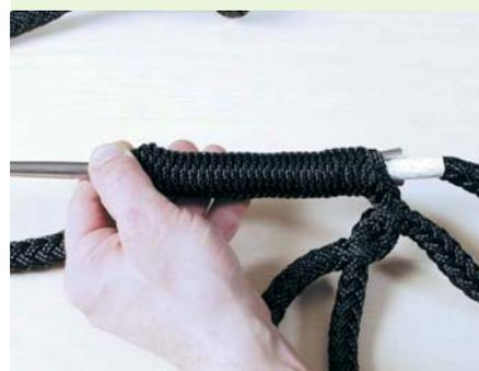
Свайка с закрепленным ходовым концом пробивается сквозь трос на нужную длину
