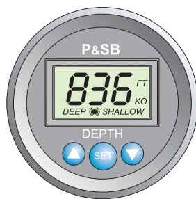
Рис. 1. В самом простом варианте, предназначенном исключительно для навигационных целей, показания глубины отображаются на жидкокристаллическом индикаторе. Незамысловатый «интерфейс» предлагает минимум дополнительных функций – как правило, перевод значений в метры, футы и морские сажени, а также подачу предупреждающего сигнала по достижении минимально допустимой глубины. Кроме того, подобный «циферблат» может использоваться в дополнение к более сложной системе – например, на дублирующем посту управления.
