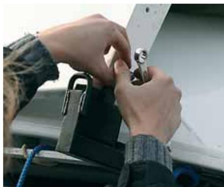
Чтобы освободить «пакет» от подрамника, нужно отвернуть пару гаек
