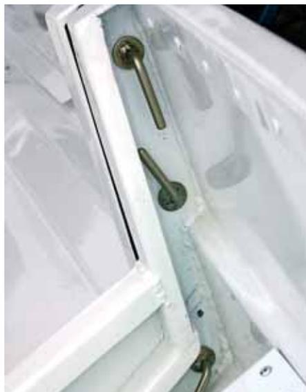
Самоконтрящиеся шпильки позволяют обойтись без второго ключа
