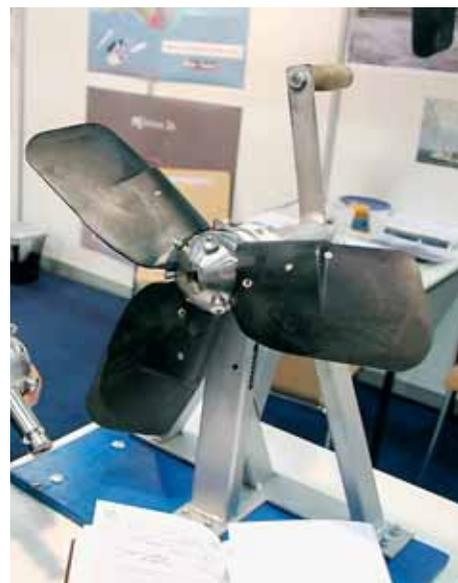
**Яхтенный винт с поворотными пластиковыми лопастями «Kiwi Prop» прост, как все гениальное**
