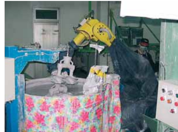
Работница «подплавляет» восковые модельки, чтобы они были гладкими, а затем сильная рука робота-манипулятора покрывает их силикатной обмазкой
