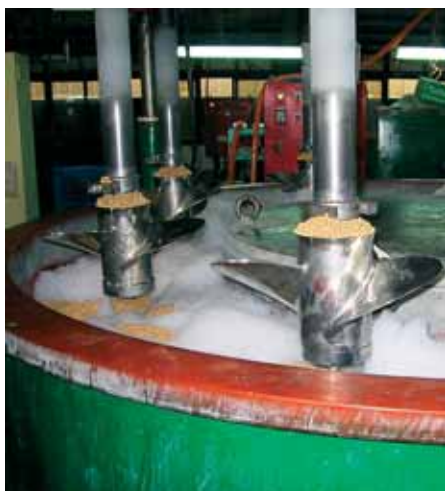
Качественная полировка винта – залог его высокой эффективности
