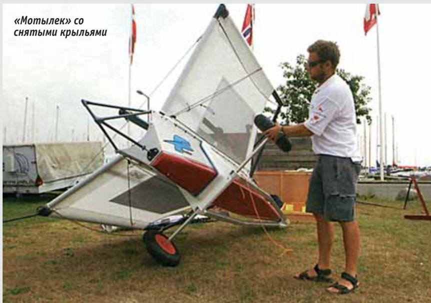
«Мотылек» со снятыми крыльями
