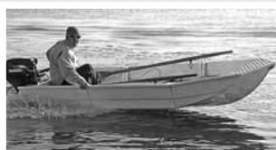
Длина – 3.56 м, ширина – 1.35 м, высота борта на миделе – 0.45 м, вес с оборуд. – 65 кг, грузоподъемн. – 260 кг, пассажироемкост. – 3 чел., мощность ПМ – 15 л.с., скорость – 35 км/ч, габариты пакета в сложенном виде – 1.55×1.35×0.6 м.
