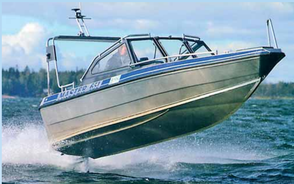
С мотором мощностью 150 л.с. лодка вела себя при прыжках более стабильно (фото из журнала «Vene»)
