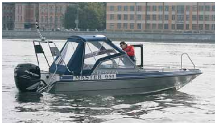
Тент-трансформер позволяет выбирать между полностью закрытым «домиком» и длинным «солнечным» навесом
