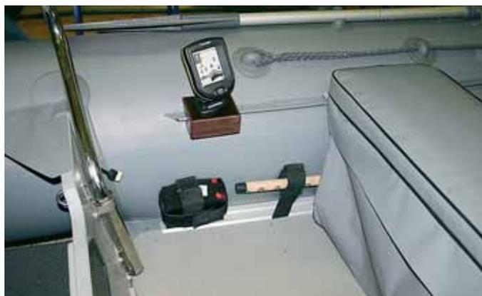
«Уголок» доработанной лодки: съемная дуга с ходовыми огнями, прожекторами и держателями для удильщ, эхолот на съемном крепежном блоке, аккумулятор и удильще на креплениях с «липучками»; водитель располагается на отдельном надувном сиденье ниже уровня борта
