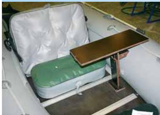
Как видно, даже на надувной лодке можно расположиться с «яхтенным» комфортом. Чтобы столик не мешал, его можно сдвинуть вбок по направляющим.
