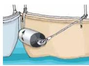
При постановке судна у стенки достаточно трех цилиндрических кранцев, при швартовке к борту другого судна лучше подстраховаться еще парой шаровидных кранцев в оконечностях
