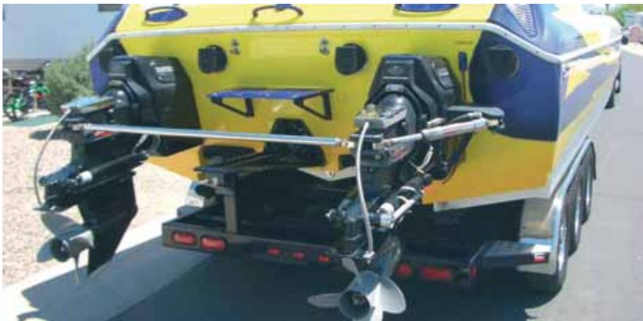
поставщик предложить более скоростных винтов для них не сможет, и их придется искать у сторонних производителей. Принято, чтобы направление вращения винтов в спарке было противоположным, ход судна в этом случае более ровный, и для этого выпускаются моторы соответствующего исполнения и левые винты. Практика, впрочем, показывает, что пара одного направления вращения работает вполне успешно, по крайней мере, в «общепользовательском» диапазоне скоростей.
