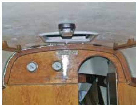
Рис. 6. Накладка, стягивающая переборку сверху
