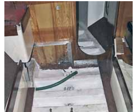
Рис. 3. Снятая табуретка. Видны уголки для ее монтажа на штатном месте
