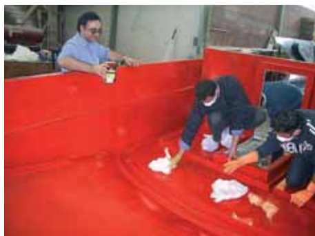
Компоненты разделительного слоя можно наносить как вручную, тампонами, так и распылителем
