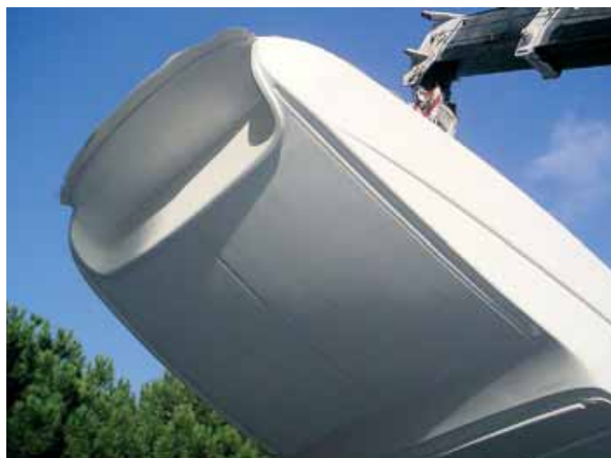
Съем готового изделия с хорошо подготовленной оснастки не представляет трудностей
