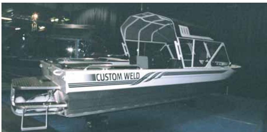
Водометный алюминиевый «Custom Weld» с 6-миллиметровым днищем. Справа – транец водометного «Harbercraft» со 160-сильным двигателем.
