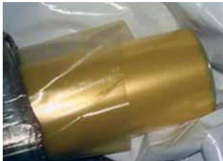
Конструкционные металлы при длительном хранении во влажных условиях судовой палубы или лодочных стоянок, как правило, склонны к коррозии, бороться с которой непросто. Американская фирма «Dr.Shrink», специализирующаяся на выпуске упаковочных материалов, предложила наносить ингибиторы коррозии — давно известные химикаты, тормозящие электрохимические процессы на поверхности металлов — на упаковочную пленку.
