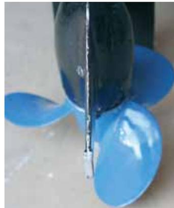
Обработанный консервирующим составом, силовой агрегат остался в полном порядке. Нижняя часть корпуса редуктора (фото справа) облезает не только от того, что мотор иногда ставится на шпору, но и от потока воды.
