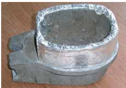
Рис. 7. Шпор после аварии
