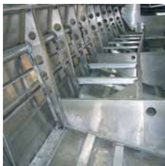
Мощный и частый набор корпуса – характерная особенность всей гаммы «КС»
