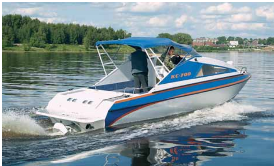
Каютный «КС-700 Экспресс» с дизелем «Steurg» и водометом «Alamarin Jet»
