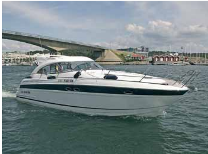
Благодаря низкому силуэту «Bavaria 42 HT» (12 м, 2xIPS600) оказалась в свежую погоду наиболее послушной – боутрастер здесь действительно ни к чему
