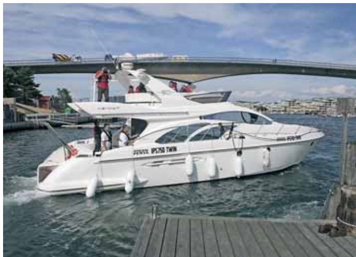
На «Azimut 50» (15 м, 2xIPS750) с высокой надстройкой при использовании «Docking station» в сильный ветер пришлось включить «вторую скорость». Джойстики установлены здесь на основном посту управления, на флайбридже и в кормовом кокпите.
