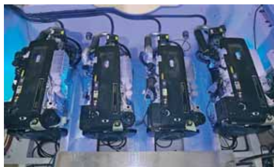
Самая крупная из участвовавших в тесте лодок – 22-метровая «Lazzara 75» под американским флагом – была оборудована сразу четырьмя IPS600
