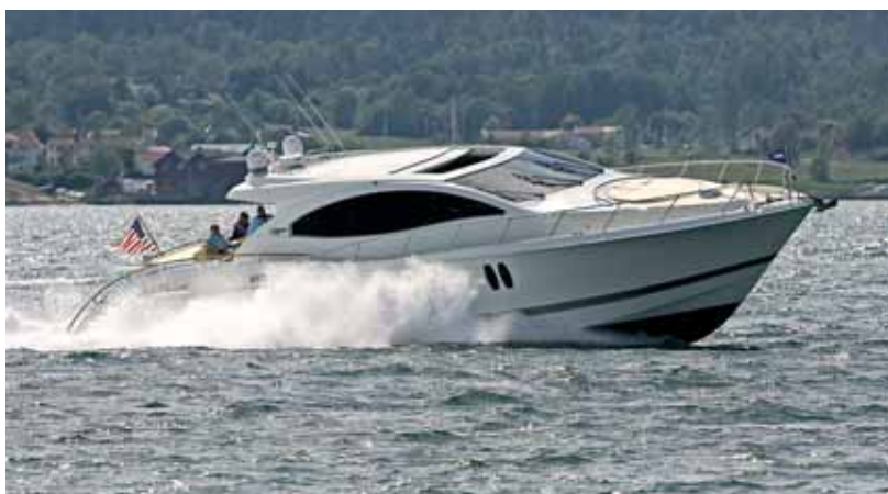
Самая крупная из участвовавших в тесте лодок – 22-метровая «Lazzara 75» под американским флагом – была оборудована сразу четырьмя IPS600
