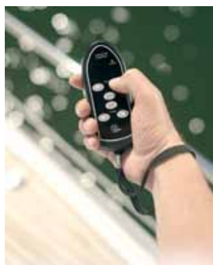
При помощи такого радиопульта можно управлять подруливающим устройством из любого места на лодке
