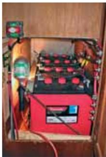
На относительно небольшой лодке можно использовать в качестве основного аккумулятора той же емкости, что и стартерный, хотя, как правило, для этих целей применяется либо одна большая батарея (100 Ач и выше), либо сразу две, соединенные параллельно
