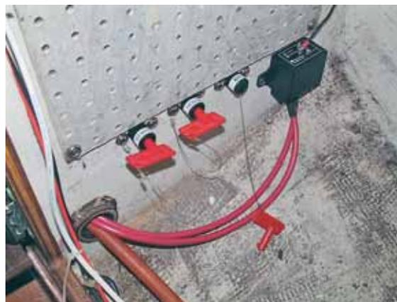
Благодаря удобству и «противоугонной» функции (не рассчитанной, впрочем, на воров-профессионалов) большое распространение получили одинарные «силовые» выключатели с вынимающимся ключом. Удобно их использовать и при монтаже схем, показанных на рис. 2–4. Единственно, терять ключи не рекомендуется.
