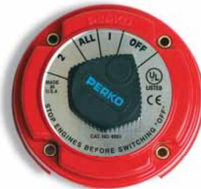
Четырехпозиционный переключатель — самый простой и дешевый вариант при установке на лодку второго аккумулятора. Эта модель рассчитана на силу тока до 360 А, т.е. требованиям к starterной проводке отвечает с запасом.
