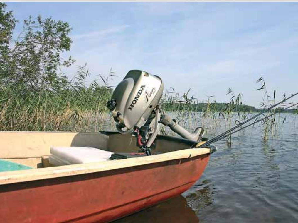
Производители уже все перья сломали и извели кучу бумаги, предупреждая обладателей четырехтактных моторов о том, что хранить и перевозить их необходимо либо в вертикальном положении, либо на том боку, на котором указано в инструкции. Но... в мастерскую по ремонту мотор с залитым маслом порой привозят в положении, не соответствующем специальным знакам на корпусе самого мотора. А что происходит в гаражах, на стоянках, да и просто на лоне природы, знает только Создатель.
