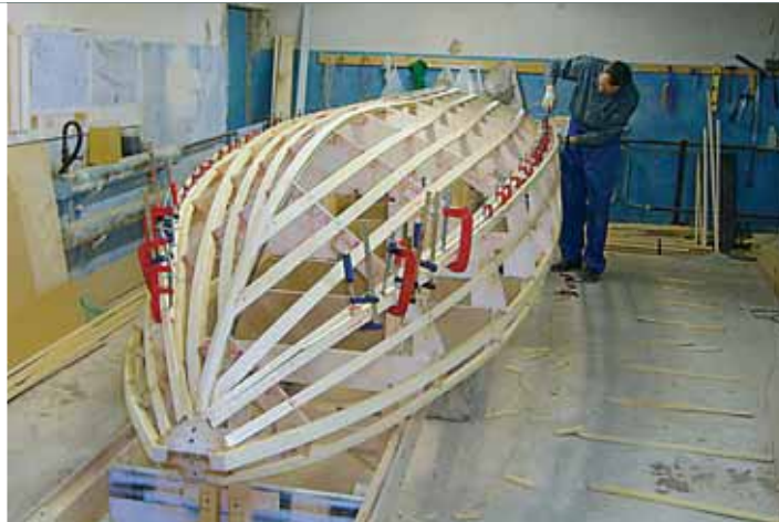
Продольный набор установлен, идет монтаж брызгоотбойников по скуле
