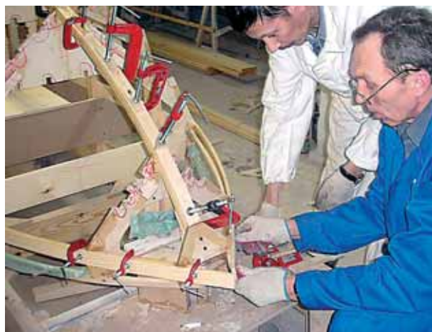
Монтаж носовой оконечности. Выклеивается форштевень, ставится форшпигель – носовой транец.
