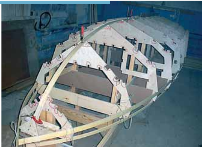
Выставленный поперечный набор подготовлен к монтажу днищевых стрингеров
