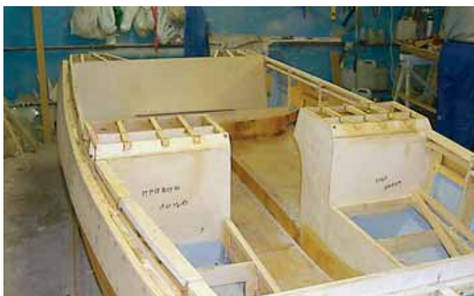
Монтаж внутренних конструкций в кокпите
