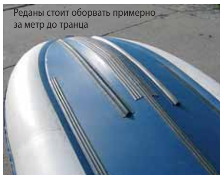
Скуловой брызгоотбойник в корме отстоит на те же 180 мм от центра баллона, но его стоило бы еще приблизить к ДП
