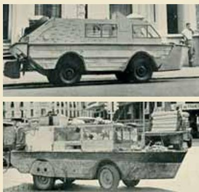
более или менее обтекаемой носовой оконечности, повышении высоты надводного борта (установлена «надстройка») и креплении под днищем закрывающего колеса нижнего танка. Все, что можно, было заполнено топливом – общий запас бензина составил 3350 л при емкости штатного бака 50 л; тем не менее в последний момент супруги закрепили на кормовой стенке надстройки «резерв» – пять 20-литровых канистр...
