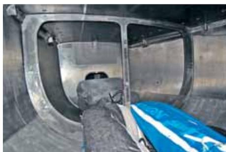
Форпик яхты. Обращает на себя внимание мощный рамный шпангоут с дополнительным пиллерсом, подкрепляющим переднюю палубу.
