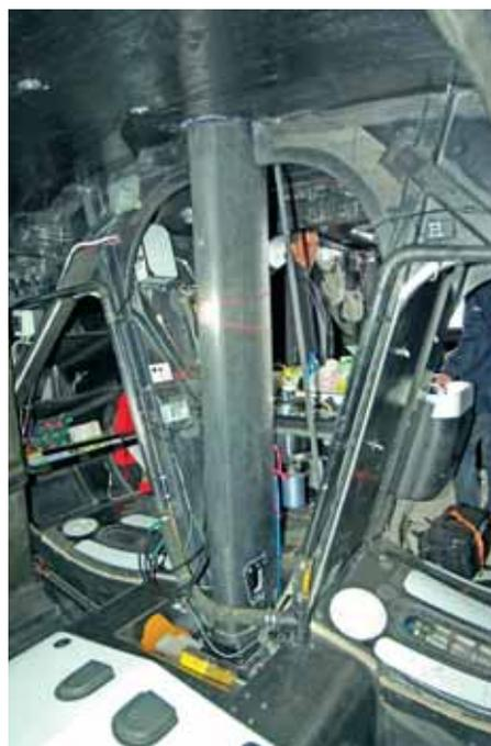
Важнейший конструктивный узел корпуса яхты: мачта, качающийся киль, наклонные «крылья» подъемных швертов и мощный рамный шпангоут, связывающий все воедино
