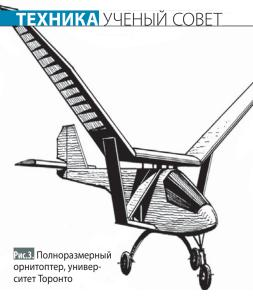
середины 90-х гг. в Аэрокосмическом университете Торонто продолжается разработка полноразмерного пилотируемого орнитоптера, оснащенного двигателем, с размахом крыльев 41.2 фута (рис.3).
