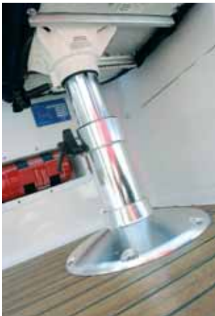
Удачный вариант расположения огнетушителя в специальной нише у ног водителя – и не мешает, и всегда под рукой
