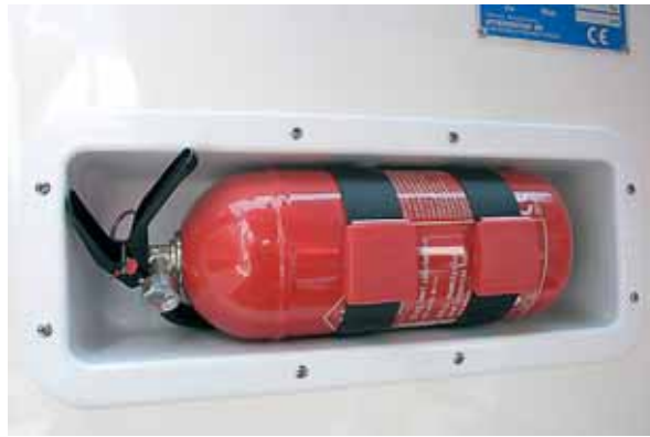
Удачный вариант расположения огнетушителя в специальной нише у ног водителя – и не мешает, и всегда под рукой
