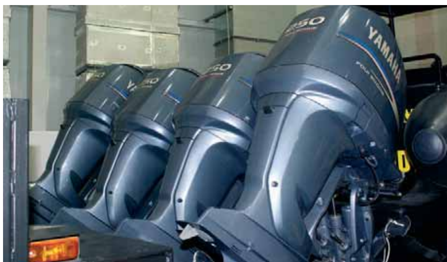
Эти четыре 250-сильных «Yamaha» висят на транце одного (но зато какого!) РИБа
