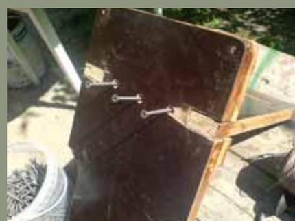
Лечим: ровняем транец, добавляем шурупы – более длинные, делаем новые крепежные пазы.
