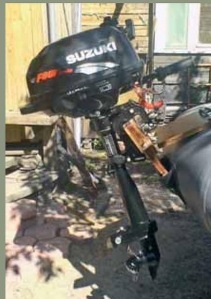
Через три часа использования лодки транец разваливается на полном ходу, и мотор, откинувшись, «хлебает» карбюратором воду! Мотор сразу заглушен, в смотровом «масляном» окне видна водомасляная эмульсия. Топливо из карбюратора слито, масло слито, налито новое, двигатель запущен. Через 5 с заглушен, масло слито, залито новое. Какие будут последствия – покажет время.
