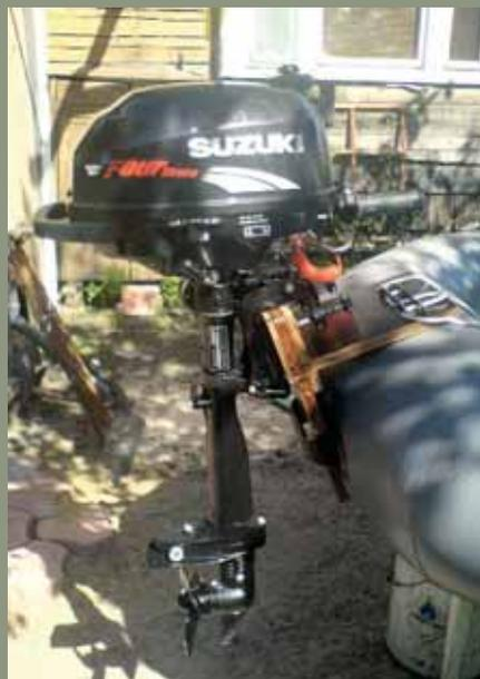
Навесной транец имеет отрицательный угол наклона, что не исправить даже регулировкой «по максимуму» углом наклона дейдвуда мотора. Добавьте 100 кг веса рулевого – и дифферент на корму заставит мотор задней ручкой почти касаться воды!
