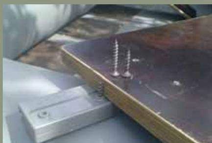
Через час эксплуатации отвалилось одно крепление баночки (сиденья). Шуруп крепления входит в фанеру всего на 4 мм. Экономия? Лечится просто – более длинными шурупами!
