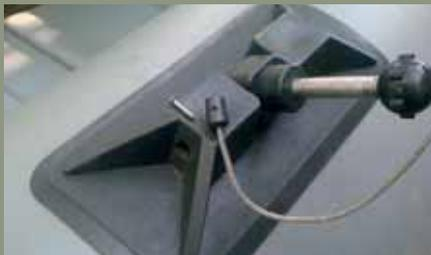
Через полтора часа эксплуатации! Опять экономия на длине шурупа. Ладно, сами поменяем на более длинный.
