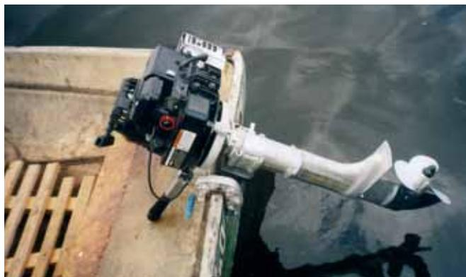
дейдвуд, проставку, редуктор в сборе, винт и вертикальный вал, словом, всю нижнюю часть мотора. Менее чем за два месяца был изготовлен третий вариант, который считаю наиболее перспективным. Пришлось сделать только алюминиевый фланец-переходник, маховик, втулку-переходник и тросик газа.
