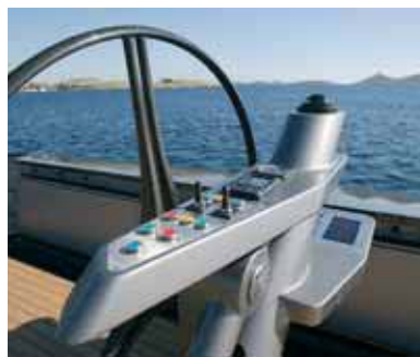
На «крыле» рулевого поста хорошо видны два джойстика, управляющих стаксель- и гика-шкотами
