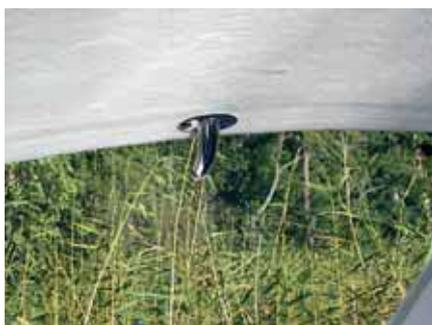
Крюк-фиксатор подъема стекла на подволоке рубки
