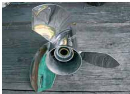
Чемпион по скорости — стальной винт «Ballistic»
