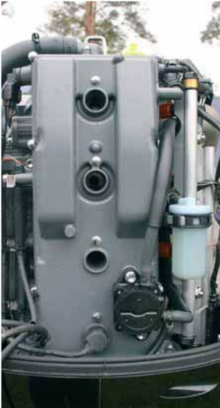
Неудобный доступ к свече зажигания IV цилиндра
