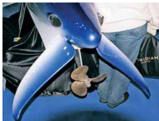
Летучая рыбка – ныряющий и выпрыгивающий из воды одноместный аппарат с 250-сильным роторным двигателем
