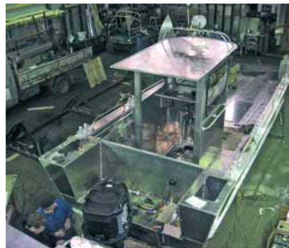
лее широкого корпуса – это вопрос времени. Днище усилено мощным продольным и поперечным набором. Толщина обшивки днища составляет 6 мм, борта – 5 мм. Непотопляемость обеспечивается делением корпуса на отсеки водонепроницаемыми переборками. В составе оборудования – две электрические и ручная помпы, а также полный коммуникационный комплекс, необходимый для работы в порту.
