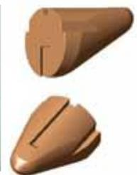
ляют конструировать плавсредства различного назначения. В поставляемом наборе – два типа модулей: цилиндрические для сборки основных объемов плавучести понтонов и конические для образования законцовок этих объемов. Благодаря коническим законцовкам удается снизить сопротивление сборного поплавка при буксировке понтона. Опирающаяся на пару таких поплавок платформа-катамаран при установке на нее двигателя становится полноценным самоходным судном.
