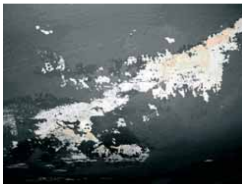
Рис. 1. Разрушение ремонтного слоя краски в районе осмотических изменений в обшивке днищевой части корпуса яхты «Princess 52» 1998 г. выпуска
