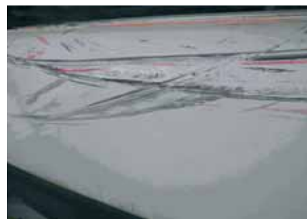
Рис. 8. Зона контакта при аварийном столкновении – нарушения непроницаемости отсутствуют
