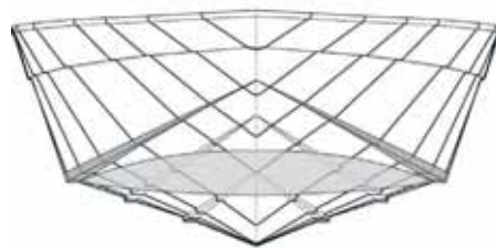
Рис. 10. Расположение на корпусе зон высокой концентрации дефектов
