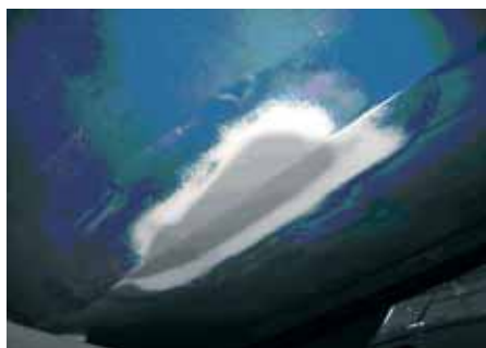
Рис. 6. Реставрированный скол продольного редана катера «Sunseeker 44 Camarque»
