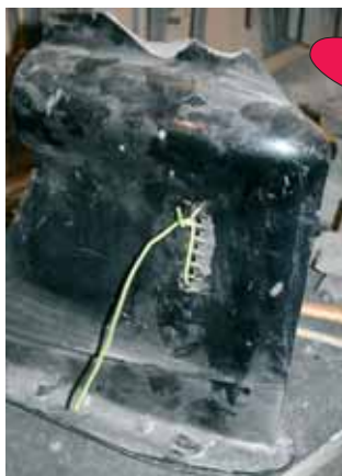
Рис. 1. Если приемные окна выполнены в виде «жаберных щелей», для аварийной подачи воды на ходу можно использовать толстую проволоку или электропровод
