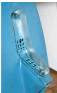
Рис. 5. На «Ветерках» используется винт левого вращения, так что и жестяную перегородку нужно устанавливать слева по ходу движения
