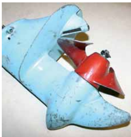
Рис. 4. Судя по всему, разработчики «Прибоя» заранее заложили в конструкцию мотора возможность добраться до дома при неисправной помпе
