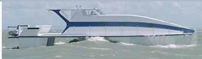
волнении до 1.5 м высотой, во-вторых, высокой экономичностью. При крейсерской скорости в 20 уз заявленный расход топлива составляет около 2 л на милю; максимальная же развиваемая скорость достигает 30 уз. В-третьих, это просторная платформа для размещения салонов, кают, оборудования для погружений и даже площадка под небольшой вертолет.
