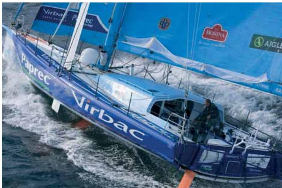
На этом снимке хорошо видна складная крыша рубки «Paprec-Virbac»
