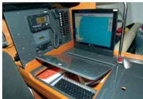
Навигационный компьютер становится нормой даже на скромных по размеру яхтах
