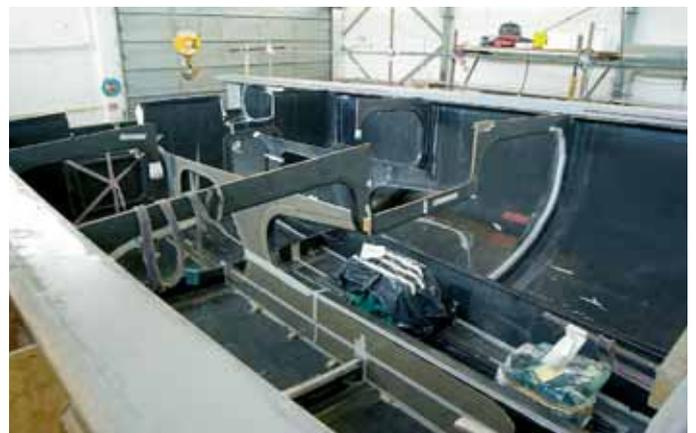
Между стрингерами уже установлены двигатель и дизель-генератор. По верху кормовой (дальней слева) переборки пройдет погон гика-шкота. (Фото отретушированы для того, чтобы скрыть положение скулы.)
