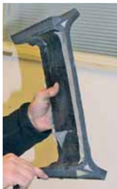
Для приформовки одних силовых элементов к другим «мокрыми угольниками» дело не ограничивается. Угля на нашу лодку не жалеют!
