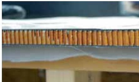
Сечение «безответственной» переборки. Даже здесь толщина угля весьма приличная.
