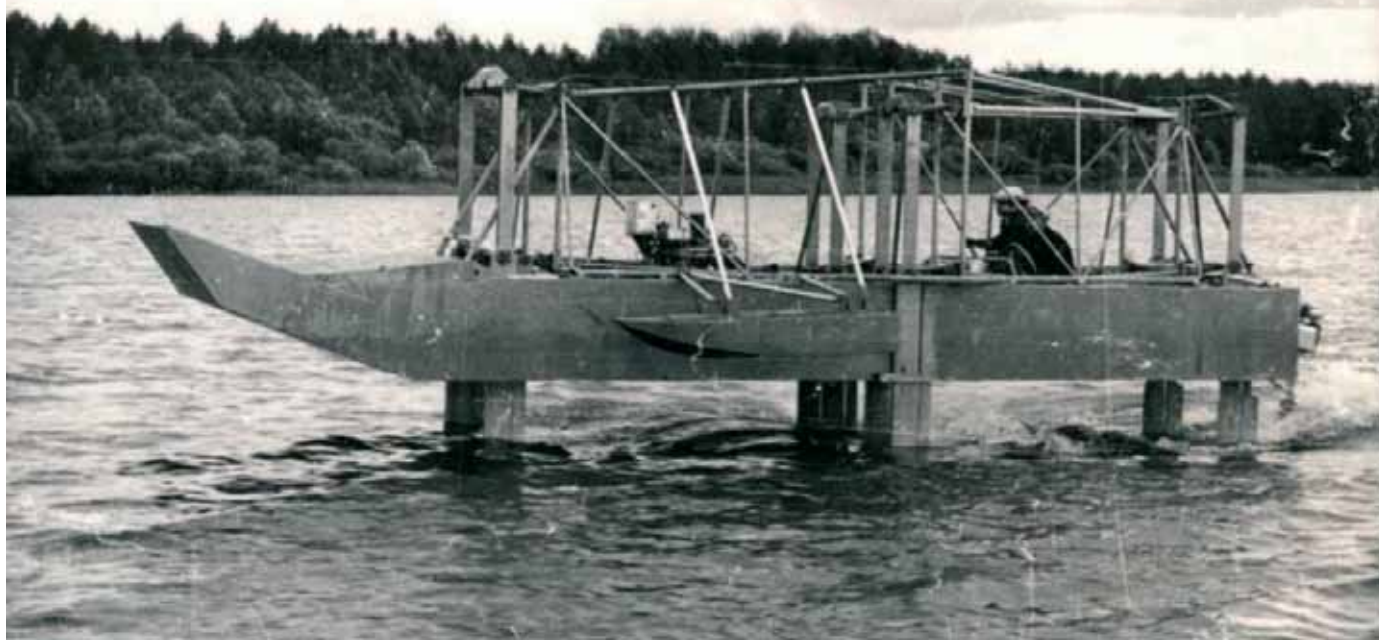
Крупномасштабная самоходная модель катера ЦАГИ с плавниковыми двигателями
