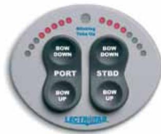
**Рис. 13.** Указатель положения электромеханических плит представляет собой, как правило, обычный «таймер», который благополучно работает и без плит, вхолостую
