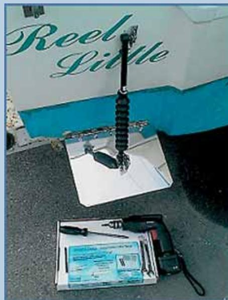
Бывает, что плиты нужны самым маленьким лодкам, особенно надувнушкам, которые при выходе на глиссирование норвят «встать свечой». В состоянии покоя и на небольших скоростях плиты «SmartTabs» под воздействием упругих элементов опущены, а с ростом скорости потока сами собой поднимаются (на некоторых моделях также предусмотрена возможность поднять их в «нулевое» положение вручную). Это забавное приспособление мы тоже постараемся опробовать на воде, после чего расскажем о своих впечатлениях.
