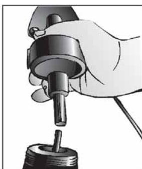
**Рис. 14.** Перед установкой указателя на гидравлической системе, скорее всего, придется заменить «обычную» верхнюю часть цилиндра на снабженную индуктивным датчиком
