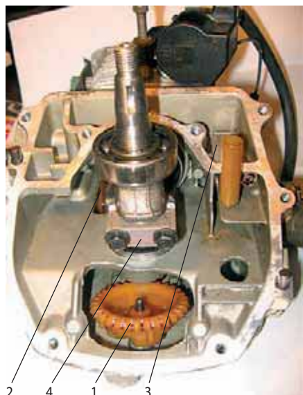
Рис.1. Картер (верхняя крышка снята): 1 – наклонная шестерня, 2 – зубчатый диск, 3 – лепестковый обратный клапан, 4 – шатун.
