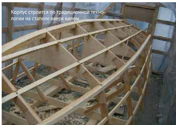
Корпус строится по традиционной технологии на стапеле вверх килем
