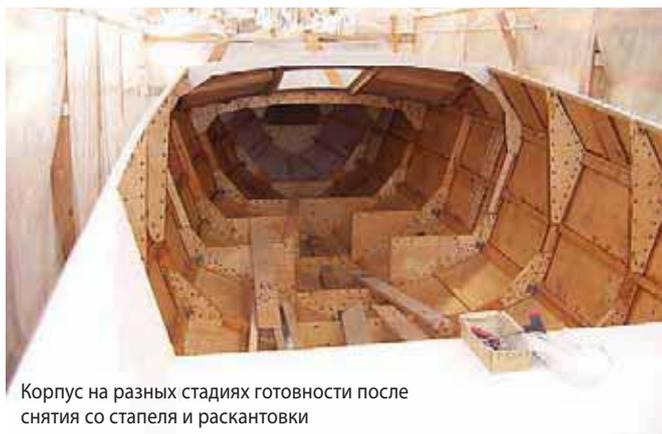
Корпус на разных стадиях готовности после снятия со стапеля и раскантовки
