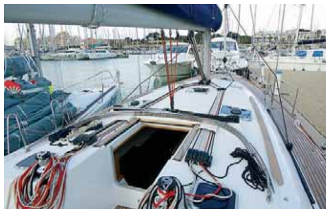
Практически весь бегучий такелаж выведен на крышу рубки, все манипуляции с парусами выполняются из кокпита
